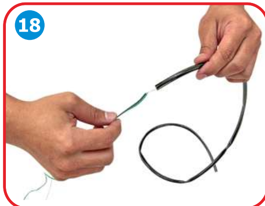
Hundred tied with wire to the wire. Cover through the pipeline has covered wire. ร้อยเส้นลวดที่ผูกกับสายไฟของฝาครอบฯ ผ่านท่อหุ้มสายไฟ
