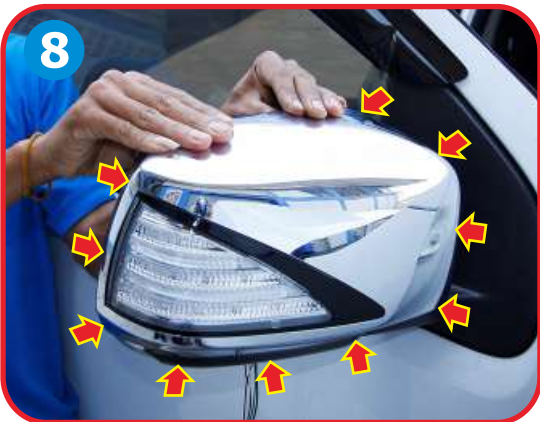
Press mirror cover firmly into position. กดฝาครอบกระจกให้ติดกับตัวเบ้ากระจก
