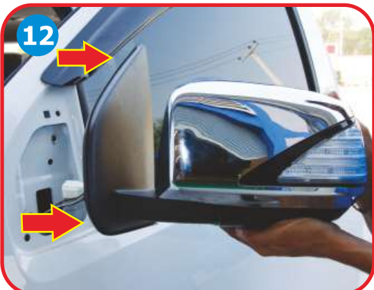
Remove to side mirror from the door. ถอดกระจกมองข้างออกจากประตู
