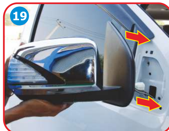
Reassemble mirror housing. ประกอบกระจกมองข้างกลับเข้าตำแหน่งเดิม
