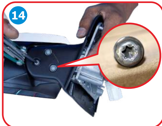
Unscrew of the leg side mirror housing ไขไขควงหัวพิเศษ ไขสกรูยึดขากระจกทั้ง 3 จุดออก
