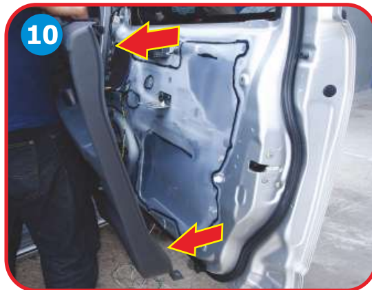
Remove door panel as shown. ถอดแผงข้างประตู
