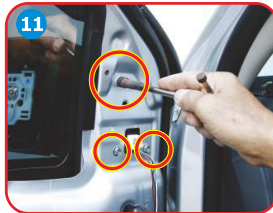
Remove 3 nuts holding side mirror. ไขน็อตยึดขากระจกทั้ง 3 จุด
