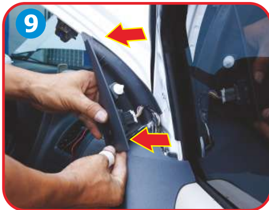
Remove panel and Remove electric mirror plug. ถอดฝาปิดกระจกมองข้าง และถอดขั้วปลั๊กไฟกระจกไฟฟ้า
