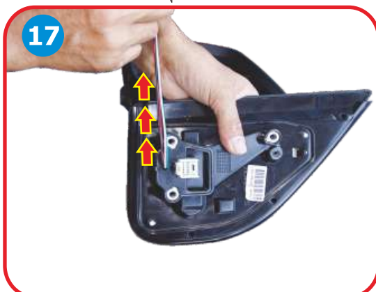
Remove protective plate on attachment leg side mirror. ถอดฝายางหุ้มขากระจกออก
