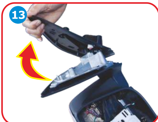
Remove protective plate on attachment leg side mirror. ถอดฝายางหุ้มขากระจกออก
