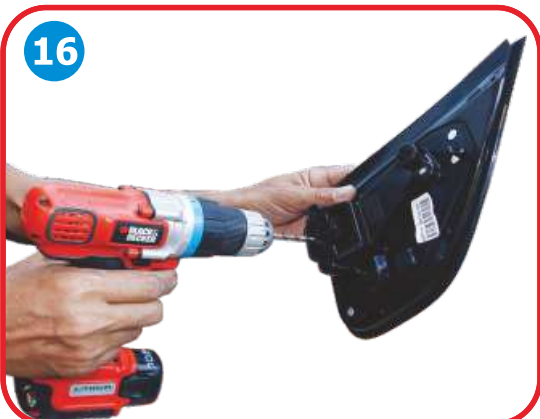
เจาะรูยางหุ้มขากระจก แล้วร้อยสายไฟดังรูป เสร็จแล้วประกอบขากระจกเข้าที่เดิม
