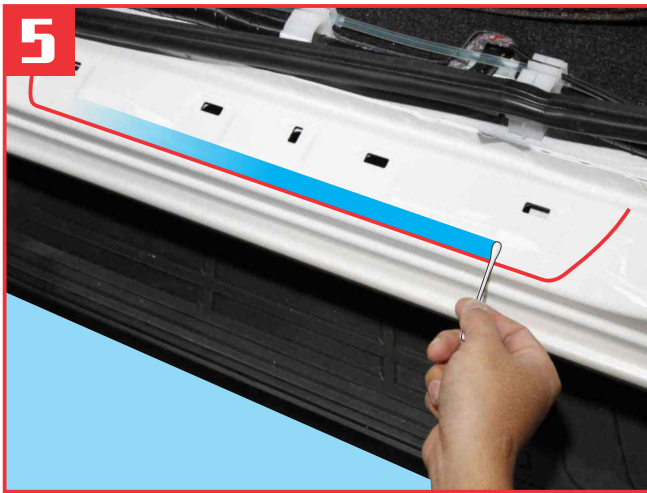
Apply primer ( provided ) before installing for better adhesion ใช้น้ำยาทารองพื้นก่อนติดตั้งเพื่อเพิ่มการยึดเกาะ ของเทปกาวอย่างเต็มประสิทธิภาพ
