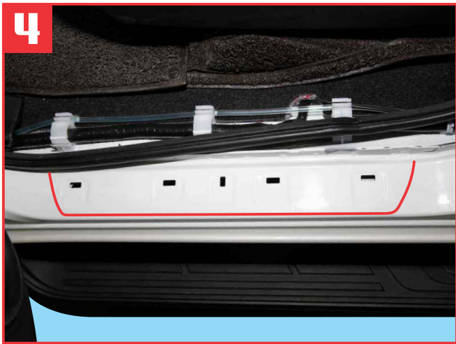
The correct position to mounting scuff plate with LED after marking position with crayon. แสดงตำแหน่งติดตั้งชายบันไดเรืองแสง
