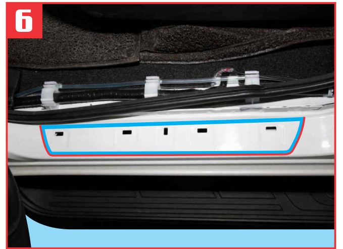
The position after apply primer ภาพแสดงบริเวณที่ทาน้ำยาทารองพื้น ก่อนติดเทปกาว
