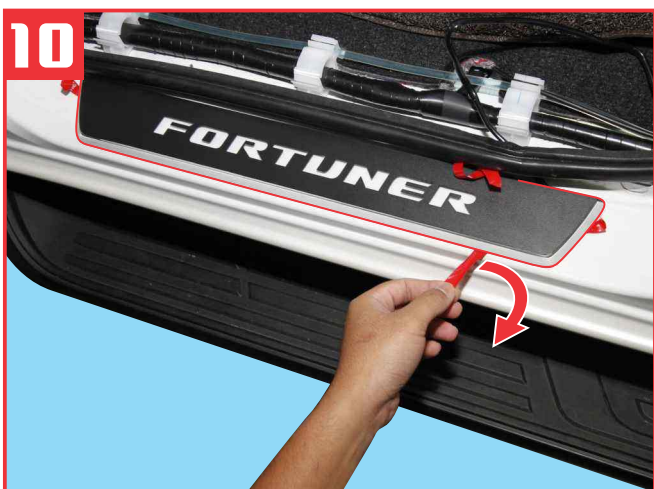
Peel off the rest of double sided tape as shown. ลอกเทปกาวออกให้หมด
