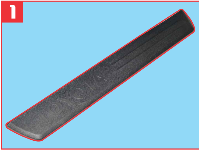
Attached original scuff plate ( the short one ) by organizing in correct position as shown. นำแผ่นปิดชายบันได(ชิ้นเล็ก)ที่ถอดไว้ ประกอบเข้าตำแหน่งเดิม เพื่อกำหนดตำแหน่งการติดตั้งชายบันไดเรืองแสง
