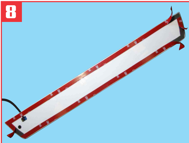
Peel off double sided tape on back side of scuff plate with LED a bit as shown. ลอกเทปกาวชายบันไดเรืองแสงออกเพียงเล็กน้อย
