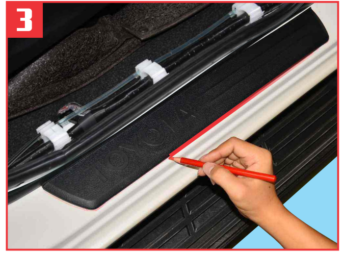
Then mark position with crayon as shown to fix mounting position. ใช้ดินสอเทียนกำหนดแนวการติดตั้ง
