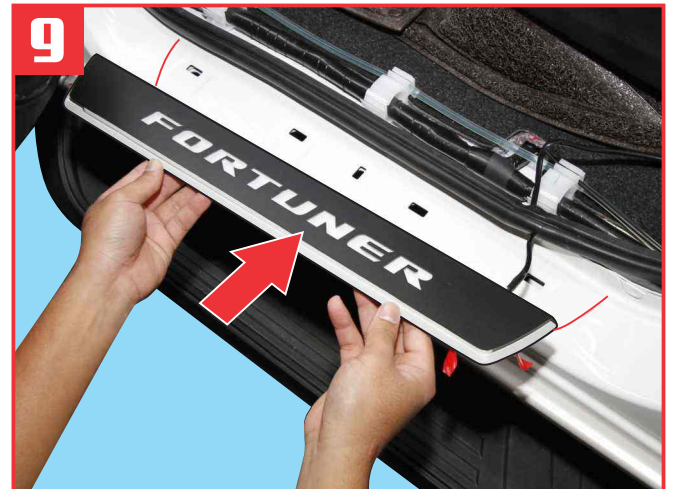
Position scuff plate with LED to mounting position as shown. ติดตั้งชายบันไดเรืองแสงเข้ากับชายบันไดของ รถยนต์ตามภาพ
