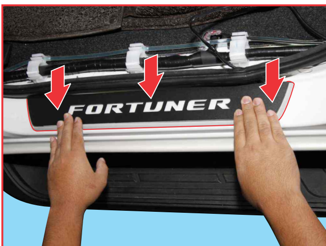
Press the scuff plate with LED firmly to vehicle. กดชายบันไดเรืองแสงให้แนบติดกับ รถยนต์อีกครั้ง
