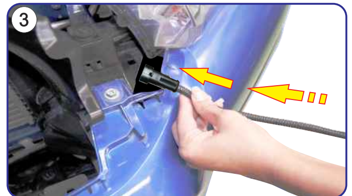
INSERT DRL WIRE THROUGH BESIDE OF HEADLAMP AS SHOWN. ร้อยสายไฟ DRL ผ่านช่องด้านข้างของไฟหน้ารถยนต์
