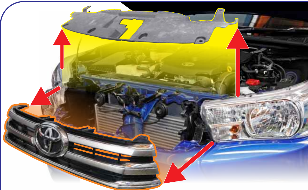
Remove front grille as shown. ถอดกระจังหน้าออกเพื่อเดินสายไฟ
