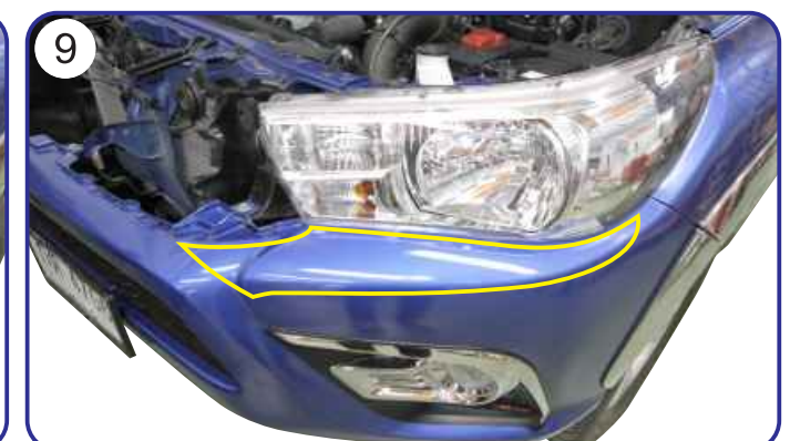
MARKING TO DRL MOUNTING POSITION WITH USING CRAYON กำหนดตำแหน่งการติดตั้งดวงไฟ DRL โดยใช้ดินสอเทียน
