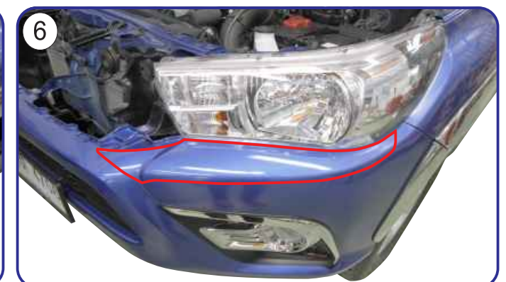
MARKING TO DRL MOUNTING POSITION WITH USING CRAYON กำหนดตำแหน่งการติดตั้งดวงไฟ DRL โดยใช้ดินสอเทียน
