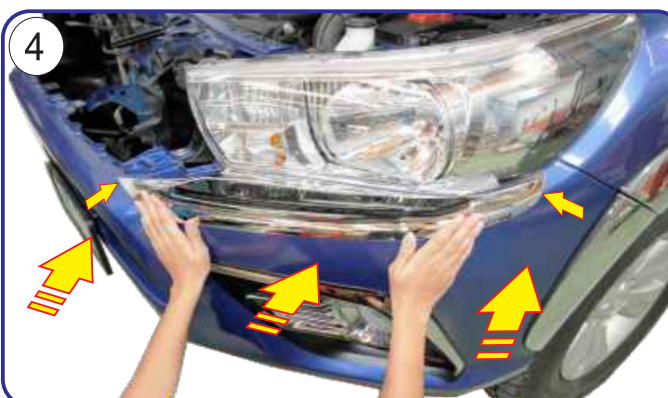
POSITION DRL TO MOUNTING POSITION AS SHOWN. นำ DRL ทาบกับบริเวณที่ติดตั้งโดยให้ขอบ ของชิ้นงานเข้ากับส่วนโค้งดังภาพ
