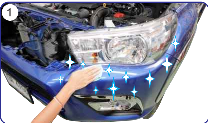
CLEAN AREA WHERE TO APPLY PARTS WITH LIQUID CLEANER FOR BETTER ADHESION. เช็ดทำความสะอาดบริเวณที่ติดตั้ง
