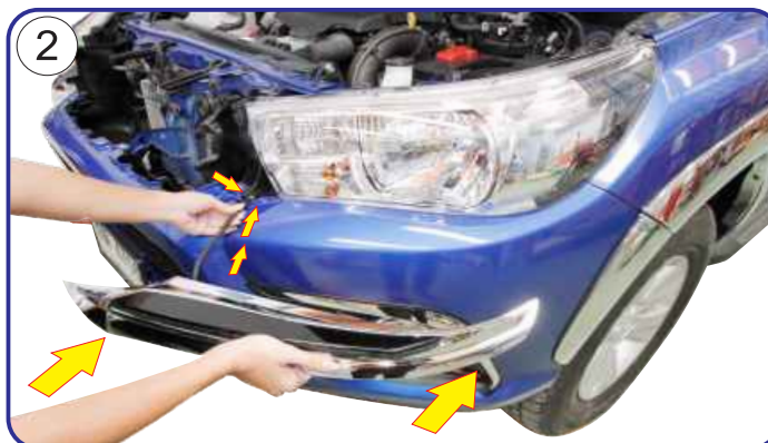
INSERT DRL WIRE THROUGH BESIDE OF HEADLAMP AS SHOWN. ร้อยสายไฟ DRL ผ่านช่องด้านข้างของไฟหน้ารถยนต์
