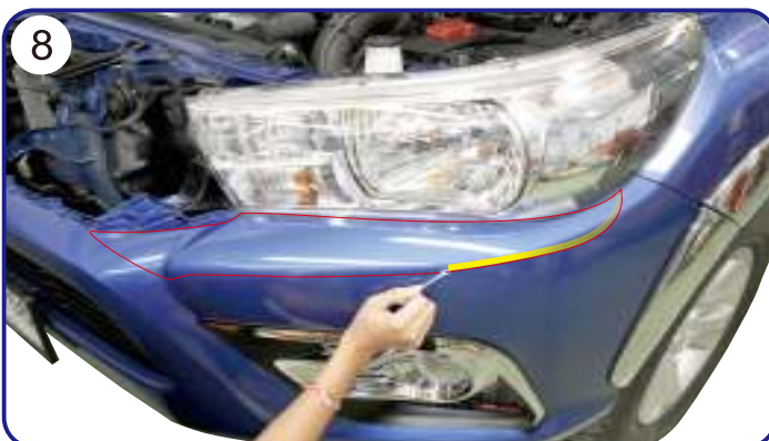
MARKING TO DRL MOUNTING POSITION WITH USING CRAYON. กำหนดตำแหน่งการติดตั้งดวงไฟ DRL โดยใช้ดินสอเทียน
