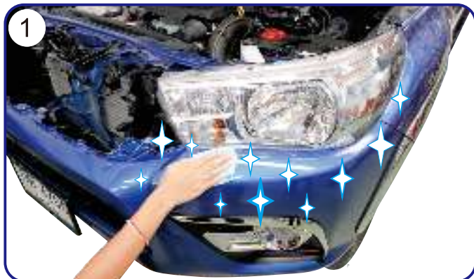
CLEAN AREA WHERE TO APPLY PARTS WITH LIQUID CLEANER FOR BETTER ADHESION. เช็ดทำความสะอาดบริเวณที่ติดตั้ง
