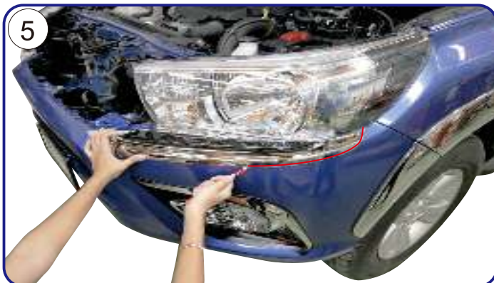
MARKING TO DRL MOUNTING POSITION WITH USING CRAYON. กำหนดตำแหน่งการติดตั้งดวงไฟ DRL โดยใช้ดินสอเทียน
