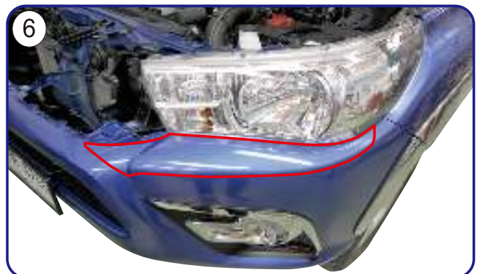
MARKING TO DRL MOUNTING POSITION WITH USING CRAYON. กำหนดตำแหน่งการติดตั้งดวงไฟ DRL โดยใช้ดินสอเทียน
