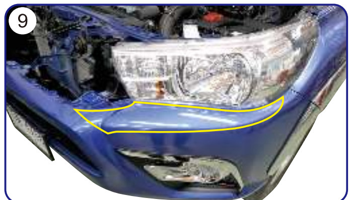
MARKING TO DRL MOUNTING POSITION WITH USING CRAYON. กำหนดตำแหน่งการติดตั้งดวงไฟ DRL โดยใช้ดินสอเทียน
