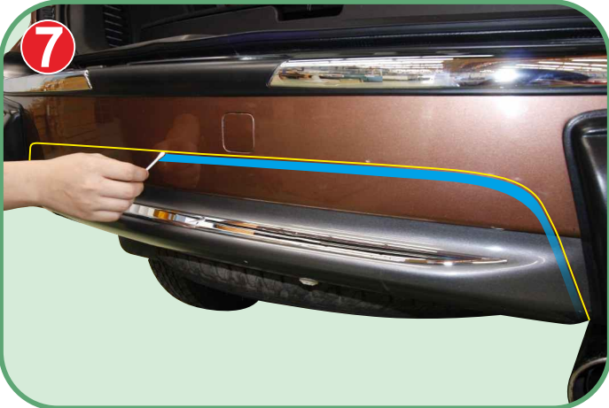
*** PLEASE NOTE! IMPORTANT PROCESS! *** USE 3 M. PRIMER FOR BETTER INSTALLATION. ใช้น้ำยารองพื้น 3 M. เพื่อช่วยในการติดตั้ง
