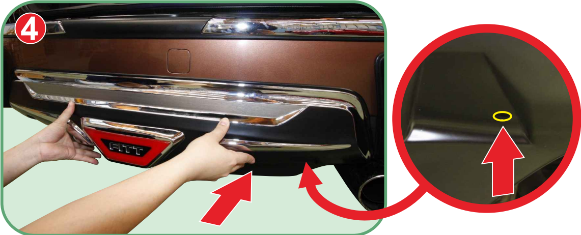
ADJUST THE REAR UNDER BODY PROTECTOR WITH THE POSITION MARKING. นำแผงกันกระแทกฯ ทาบกับบริเวณที่ติดตั้ง โดยให้รูยึดชิ้นงานตรงกับรูยึดด้านล่างกันชนหลังทั้ง 2 ข้าง
