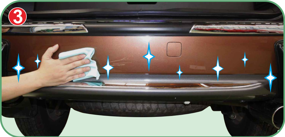
CLEAN UP AREA WHERE TO APPLY PARTS FOR BETTER ADHESION. เช็ดทำความสะอาดพื้นที่ ที่จะติดตั้งด้วยแอลกอฮอล์ เพื่อการยึดเกาะที่ดีของเทปกาว 3M.
