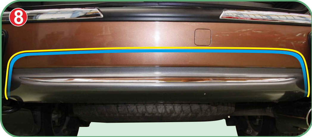
APPLY PRIMER (PROVIDED) ON MARKING POSITION FOR BETTER ADHESION. ทาน้ำยารองพื้นบริเวณด้านในของพื้นที่ที่กำหนดไว้ เพื่อการยึดเกาะของเทปกาว 3M. อย่างเต็มประสิทธิภาพ
