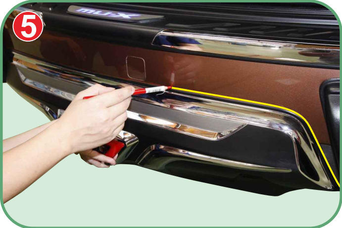
THEN MARK POSITION WITH CRAYON. ใช้ดินสอเทียนกำหนดตำแหน่ง เพื่อทาน้ำยารองพื้นก่อนติดเทปกาว
