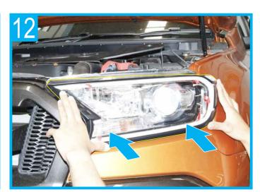
Attach head lamp cover into position as shown. นำฝาครอบไฟหน้าฯ ทาบกับตัวรถยนต์ ดังภาพ
