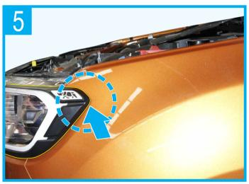
Use crayon draw line as a guidefor double sided tape. ใช้ดินสอเทียนกำหนดแนวการติดกาว
