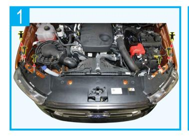
Removing the screw attack the head lamp of thecar before installing as photo show. การถอดชุดสกรูยึดชุดดวงไฟหน้ารถยนต์ก่อนติดตั้ง ดังภาพ
