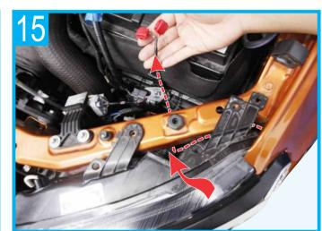
Insert the wires of the head lamp cover with LED front position on the back of the head lamp of the car as photo show. ร้อยสายไฟของฝาครอบไฟหน้าฯ ผ่านช่องด้านหลัง ของไฟหน้ารถยนต์ตามภาพ
