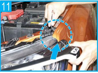
Insert the wires of the head lamp cover with LED front position above the head lamp of the car as photo show. ร้อยสายไฟของฝาครอบไฟหน้าฯ ไว้ด้านบนของไฟหน้ารถยนต์ตามภาพ
