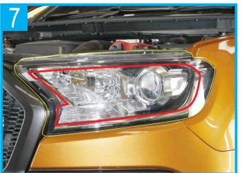
Pre-Fix the mounting point as shown. แสดงบริเวณที่ใช้ติดตั้ง
