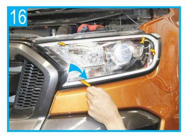
Then peel off the double side tape as shown. ลอกเทปกาวออกให้หมด ดังภาพ
