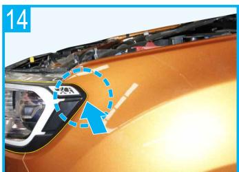
Adjust the head lamp with the position as shown. จัดตำแหน่งฝาครอบไฟหน้าฯ เข้ากับไฟหน้าของรถยนต์ ดังภาพ
