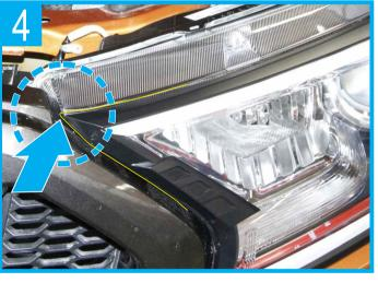
Adjust the head lamp cover with the position as shown. จัดตำแหน่งฝาครอบไฟหน้าฯเข้ากับไฟหน้าของรถยนต์ ดังภาพ
