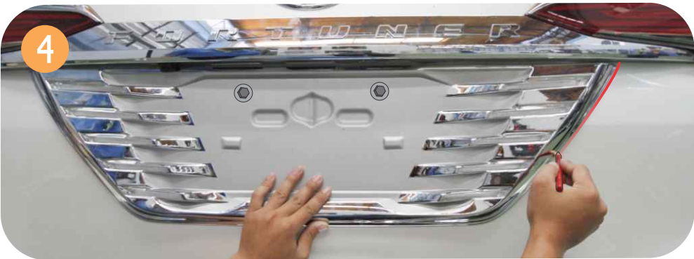
Use colored pencil draw line as a guide for double sided tape. ใช้ดินสอเขียนกำหนดแนวการติดเทป
