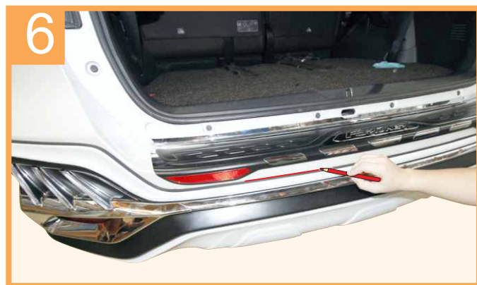
Mark position with crayon as shown then remove Rear skirt with LED from car for step. 7 ใช้ดินสอเทียนกำหนดแนวการประกอบติดตั้ง
