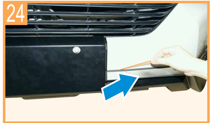
Peel off the rest of double-sided tapes on front skirt with DRL as shown ลอกเทปกาชุดสเกิร์ตหน้าออกทั้งหมด ตามภาพ
