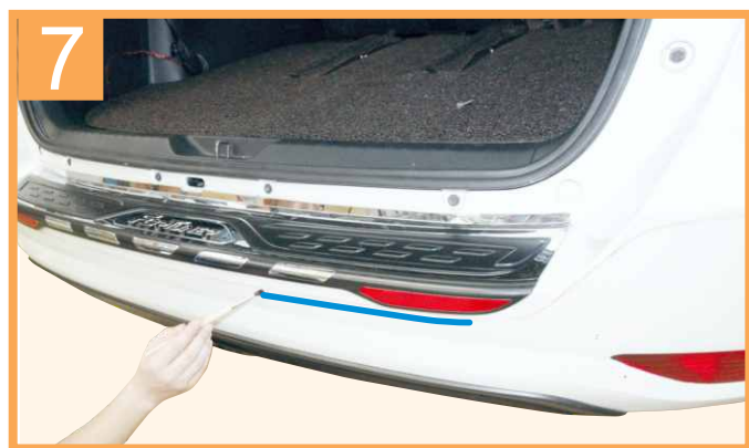
** PLEASE NOTE! IMPORTANT PROCESS** 7. Apply primer (provided) on marking position as shown for better adhesion ทาน้ำยารองพื้นก่อนติดตั้งเพื่อเพิ่มการยึดเกาะของเทปกาวอย่าง เต็มประสิทธิภาพ ตามภาพ
