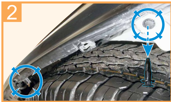
Remove screws and grommets under rear fender flare as shown ถอดสกรูและคลิปล็อคพลาสติก ได้ขั้วล่อหลังออก ตามภาพ
