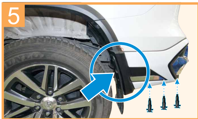
Adjust the rear skirt with LED on correct position as shown then screws (original) temporarily (not be tight) ใช้คลิปล็อคยึดชุดสเกิร์ตหลังไว้ชั่วคราว ตามภาพ
