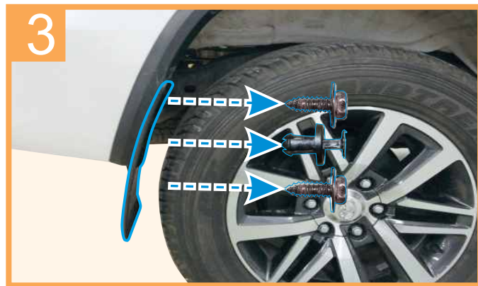
Remove screws and grommets under rear fender flare as shown ถอดสกรูและคลิปล็อคพลาสติก ได้ขั้วล่อหลังออก ตามภาพ
