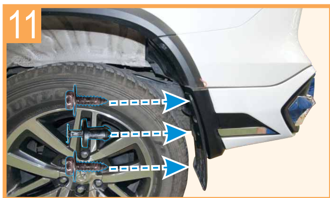
Reassemble screw and grommet to original position as shown ยึดสกรูและคลิปล็อคพลาสติกเข้าตำแหน่งเดิม ตามภาพ
