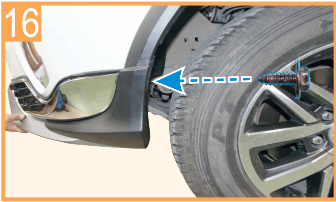
Screw (original) front skirt with DRL to car as shown ใช้สกรูยึดชุดสเกิร์ตหน้าเข้ากับตัวรถยนต์ ตามภาพ
