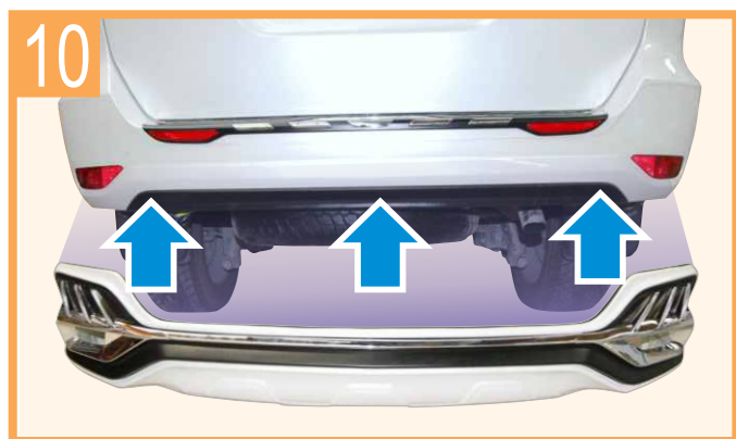
Mounting rear skirt with LED cover original as shown. ติดตั้งชุดสเกิร์ตหลัง ตามภาพ
