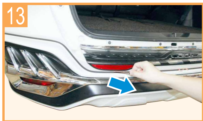
Peel off the rest of double sided tapes as shown ลอกเทปกาวยึดขอบยางสเกิร์ตหลังออกทั้งหมด
