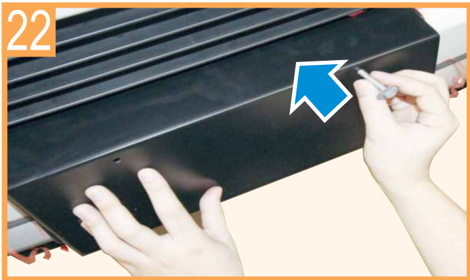
Screw (provided) on base plate (provided) together with License Plate ** on picture did not show license plate ** ใช้สกรูยึดฐานรองป้ายทะเบียน (ติดตั้งพร้อมแผ่นป้ายทะเบียนรถยนต์)
