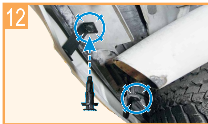
Reassemble screw and grommet to original position as shown ยึดสกรูและคลิปล็อคพลาสติกเข้าตำแหน่งเดิม ตามภาพ
