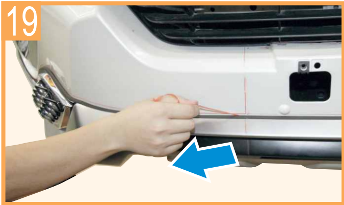
Peel off double-sided tapes on front skirt with DRL a bit to fitting base plate (provided) ลอกเทปกาออกให้เลยตำแหน่งฐานรองป้ายทะเบียน ตามภาพ
