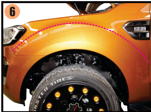
6) Correct position to apply primer แสดงตำแหน่งทาน้ำยารองพื้น(3M)
