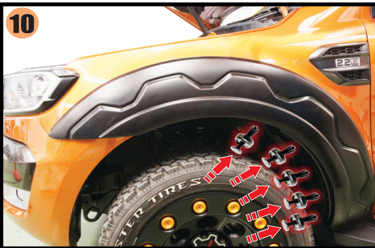
10) Reassemble screw (original) into original position as shown ยึดคลิปล็อคพลาสติก กลับเข้าตำแหน่งเดิม
