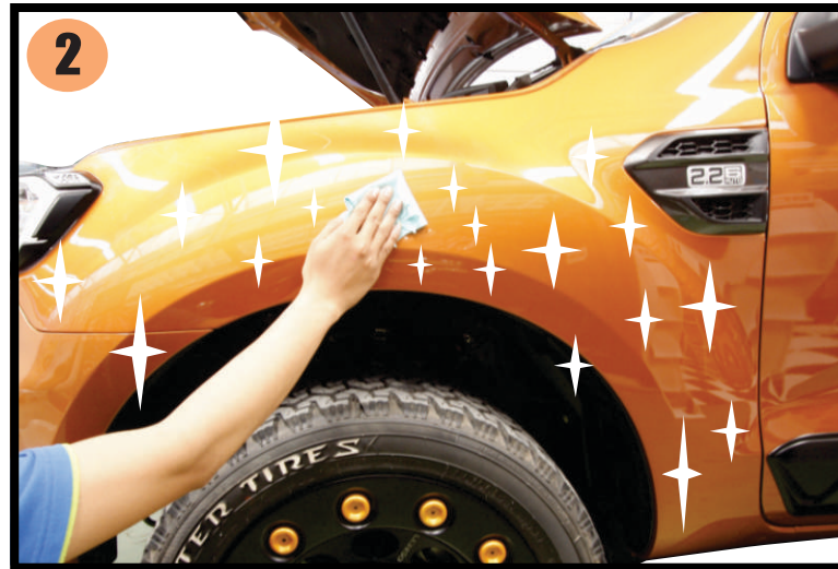
2) Wipe installation area clean with liquid cleaner for better adhesion เช็ดทำความสะอาดพื้นที่ติดตั้งเพื่อการยึดเกาะที่ดีของเทปขาว 3M
