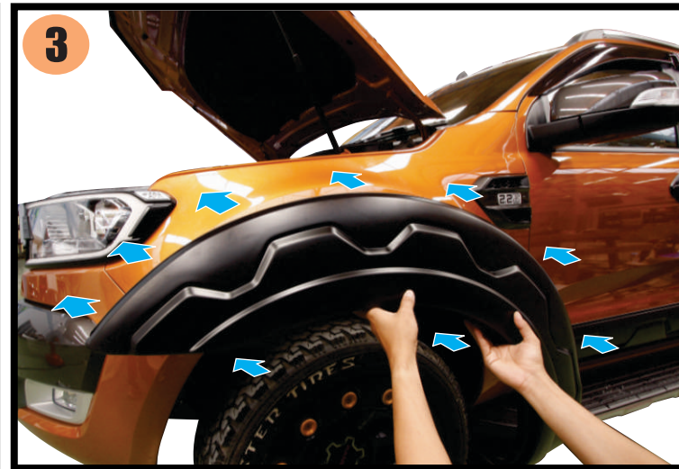
3) Attached front fender flare on correct position as shown ทาบคิ้วล้อหน้าเข้ากับตัวรถ
