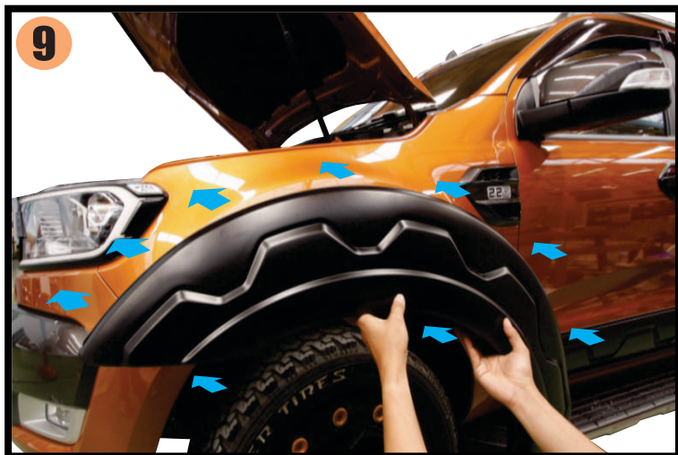
9) install front fender flare on the car as shown ติดตั้งคิ้วล้อหน้าเข้ากับตัวรถ
