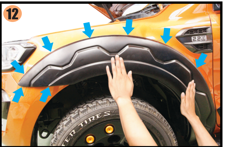
12) Press area as per arrow firmly กดคิ้วล้อหน้าให้แน่นสนิทกับตัวรถ
