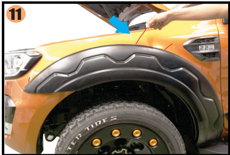
11) Peel off the rest of double sided tape as shown ลอกเทปขาวออกให้หมด
