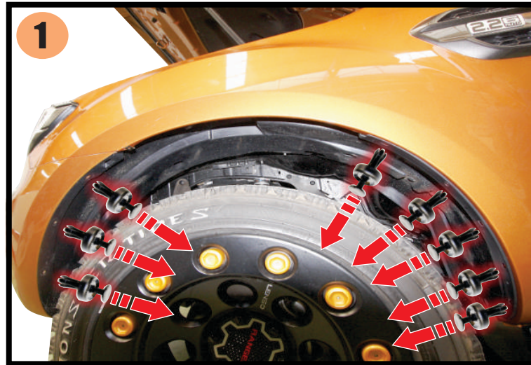
1) Remove original screw on position as shown ใช้ไขควงแฉกไขคลิปล็อคพลาสติกออก ดังภาพ
