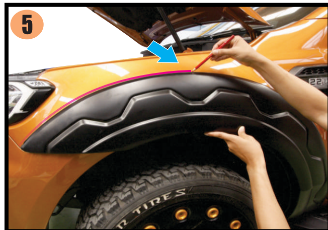
5) Marking position with crayon then remove parts ใช้ดินสอเทียนกำหนดแนวการติดกาว
