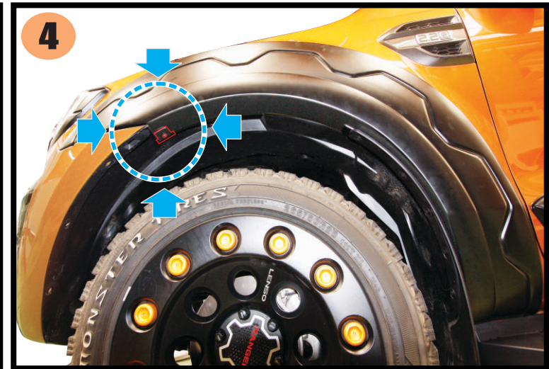
4) Mounting speed nut #12 (provided) into the car ยึดคลิปล็อค#12 ที่ให้มาในกล่อง เข้าตำแหน่ง ดังภาพ
