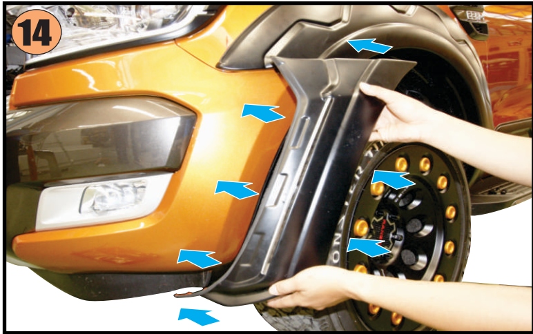
14) Attached front fender flare with DRL on correct position as shown ทาบคิ้วล้อหน้าDRLเข้ากับตัวรถ
