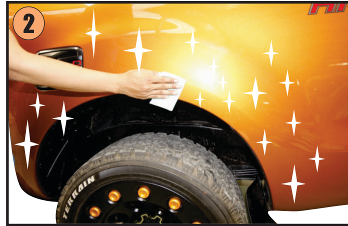
2) Wipe installation area clean with liquid cleaner for better adhesion เช็ดทำความสะอาดพื้นที่ติดตั้งเพื่อการยึดเกาะที่ดีของเทปกาว 3M
