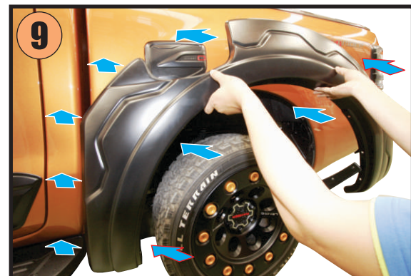
9) Install rear fender flare on the car as shown. ติดตั้งคิ้วล้อหลังเข้ากับตัวรถ
