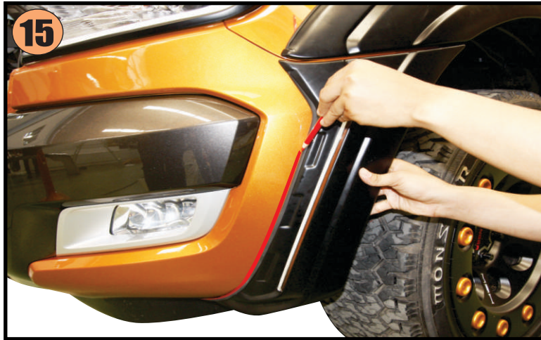
15) Mark position with crayon ใช้ดินสอเทียนกำหนดแนวการติดกา
