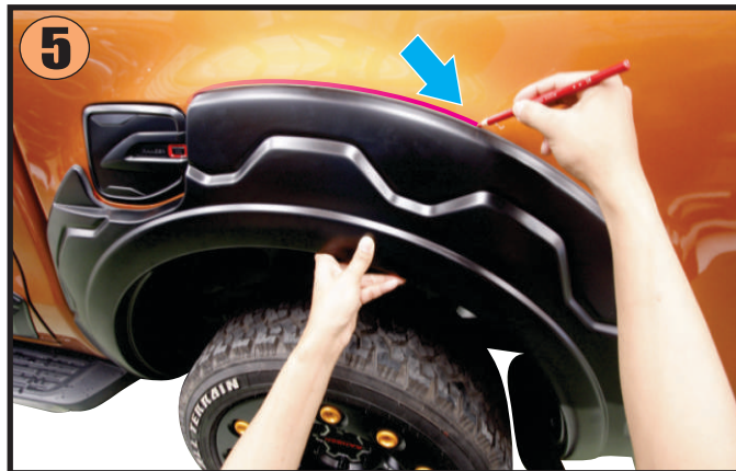
5) Marking position with crayon then remove parts. ใช้ดินสอเทียนกำหนดแนวการติดกาว
