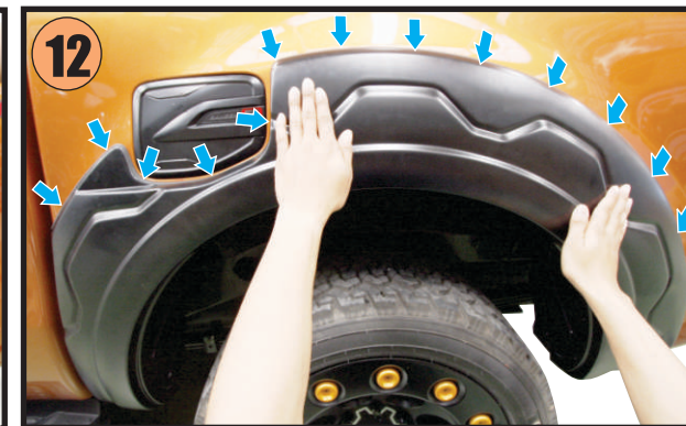
12) Press area as per arrow firmly กดคิ้วล้อหลังให้แน่นกับตัวรถ
