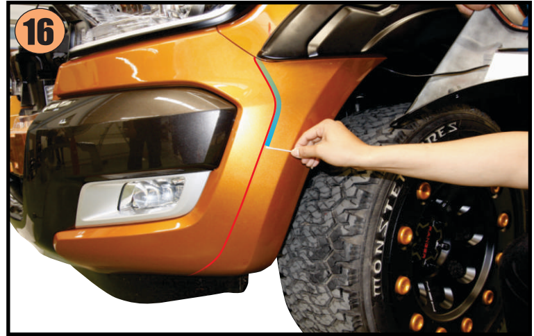
16) ** PLEASE NOTE ! IMPORTANT PROCESS! Apply primer (provided) before installing for better adhesion ทาน้ำยา พายเมอริ์ ในบริเวณที่กำหนดก่อนการติดตั้งเพื่อการยึดเกาะของเทปกา
