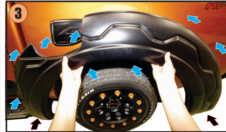
3) Attached rear fender flare on correct position. ทาบคิ้วล้อหลังเข้ากับตัวรถ
