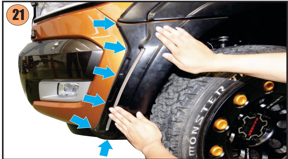
21) Press area as per arrow firmly. กดคิ้วล้อหน้าDRLให้แน่นสนิทกับตัวรถ
