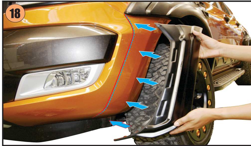
18) Install front fender flare with DRL on the car as shown ติดตั้งคิ้วล้อหน้าDRLเข้ากับตัวรถ
