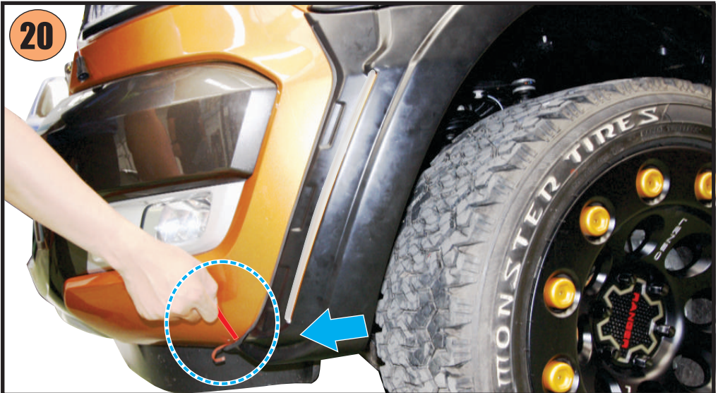
20) Peel off the rest of double sided tape as shown. ลอกเทปกาออกให้หมด
