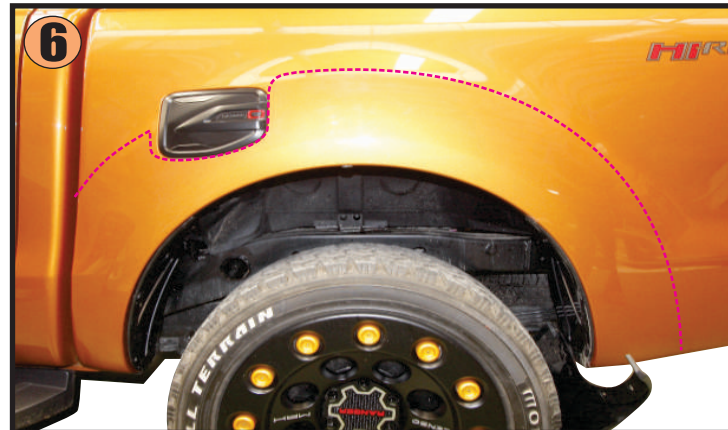
6) Installation position แสดงตำแหน่งทาน้ำยารองพื้น(3M)
