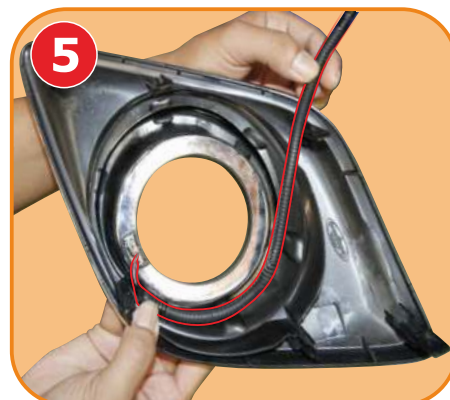
จัดสายไฟดวงไฟ DRL ตามภาพ
