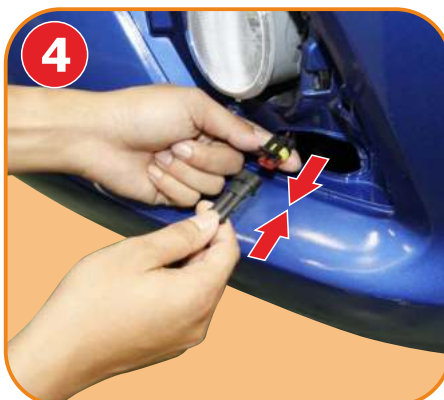
เชื่อมต่อขั้วปลั๊ก DRL เข้ากับขั้วปลั๊กของ ชุดกล่องควบคุม ก่อนติดตั้งดวงไฟ DRL
