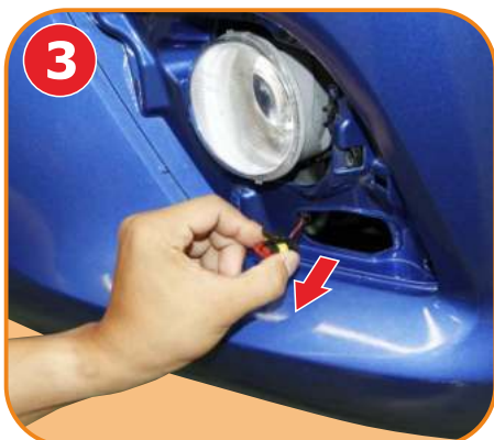
ร้อยขั้วต่อสายไฟผ่านช่องไฟตัดหมอก ตามภาพ
