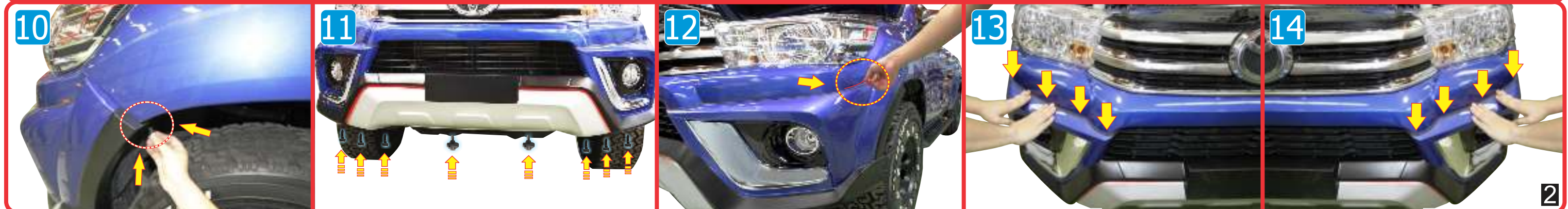
10 & 11) Reassemble original screw and grommet on the original position as shown. ยึดคลิปพลาสติกและไขสกรู กลับเข้าตำแหน่งเดิม
