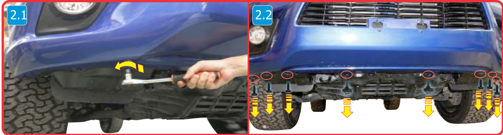
2.1 & 2.2) Remove screw and grommet on original front bumper as shown ใช้ประแจเบอร์10 กับไขควงปากแบนไขสกรูและคลิปพลาสติกออก ดังภาพ
