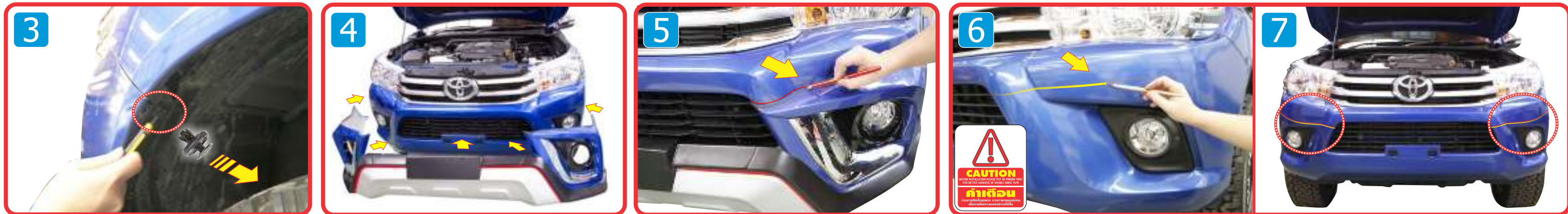
3) Loosen the screw and grommet on fender flare(original) as shown. ถอดคลิปพลาสติกออกโดยใช้ไขควงปากแบน 4) Attach front skirt on front bumper to check and mark the position. ทาบสเกิร์ตหน้าเข้ากับตัวรถ 5) Mark position with crayon as shown. ใช้ดินสอเขียนกำหนดตำแหน่งติดตั้ง 6) Apply primer (provided) on marking position as shown for better adhesion. ทาหน้ารองพื้น (3M) ก่อนติดตั้ง ตามตำแหน่งที่กำหนดไว้ 7) Correct position (red cycle) to apply primer.
