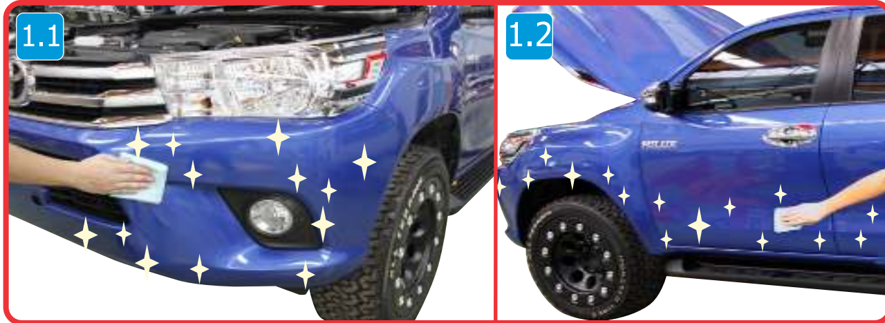
1.1 & 1.2) Clean up area where to apply parts for better adhesion เช็ดทำความสะอาดพื้นผิวก่อนติดตั้ง
