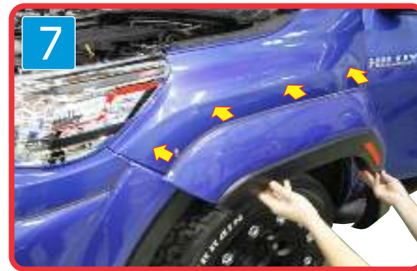
7 ) Install fender flare in correct position as shown. ติดตั้งขอบซุ้มล้อหน้าเข้ากับตัวรถ
