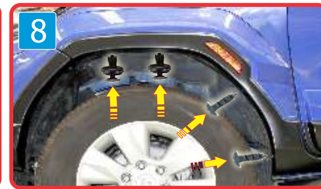
8 ) Reassemble original screw grommet on the original position as shown and another 2 positions in Red cycle as shown using screw provided ยึดคลิปล็อคพลาสติกและสกรู กลับเข้าตำแหน่งเดิม โดยใช้สกรูเกลียวปล่อย ที่ให้มาในกล่อง ดังภาพ
