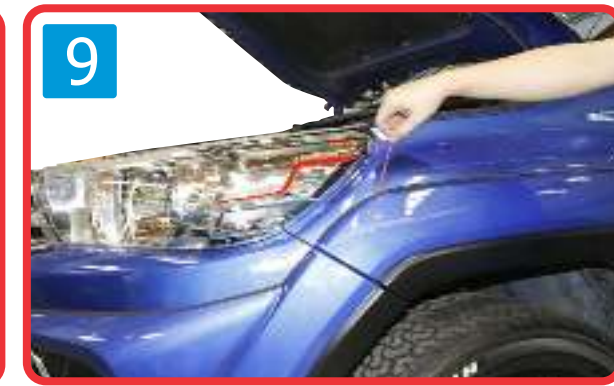
9 ) Peel of the rest of double sided tape as shown. ลอกเทปกาว(3M)ออกทั้งหมด ดังภาพ
