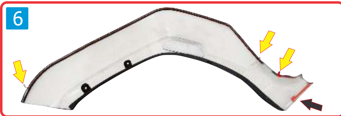
6 ) Peel off small parts of double sided tape a bit on back side of fender flare as shown. ลอกเทปกาว(3M)ออกเพียงบางส่วนดังภาพ
