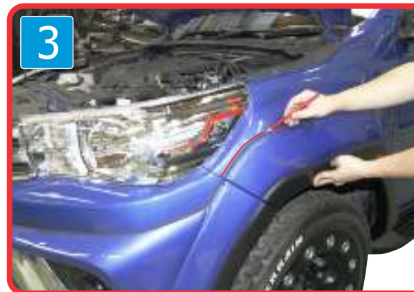
3 ) Mark position with crayon as shown. ใช้ดินสอเทียนกำหนดตำแหน่งเพื่อทาน้ำยารองพื้น(3M)
