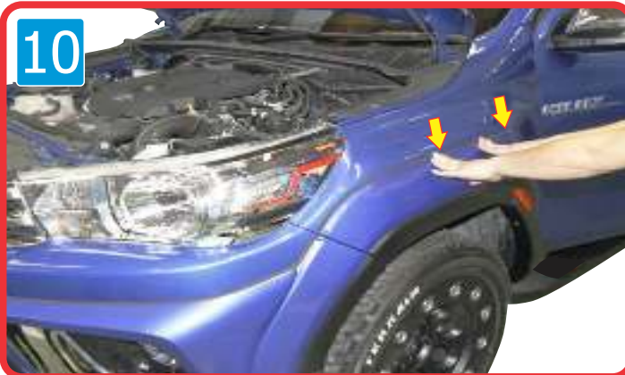
10 ) Press it firmly as shown กดขอบซุ้มล้อหน้าให้แน่นติดกับตัวรถ
