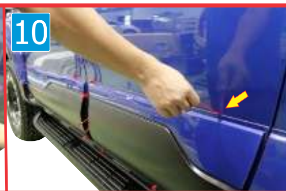
9 & 10) Peel off the rest of double sided tape as shown ลอกเทปกาว(3M)ออกทั้งหมด ดังภาพ
