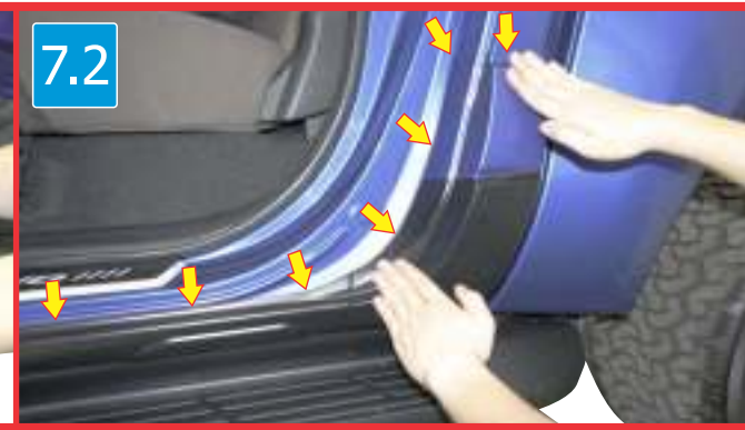
7.1 & 7.2) Press it firmly as shown. กดชุดสเกิร์ตข้าง ให้แน่นติดกับตัวรถ
