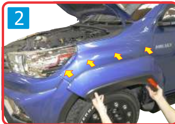
2 ) Attach fender flare on car as shown. ทาบขอบซุ้มล้อหน้าเข้ากับตัวรถ
