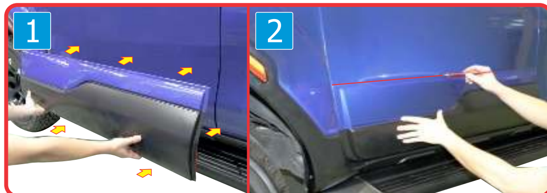
1 & 2 ) Attached front body cladding to marking position with crayon as shown. ทาบกาบข้างประตูหน้า เข้ากับตัวรถ แล้วใช้ดินสอเขียนขีดเส้น เพื่อกำหนดตำแหน่ง
