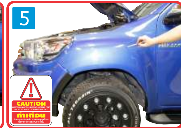
5 ) Please note! Important process. Apply primer (provided) on marking position as shown for better adhesion. สำคัญมากห้ามข้ามขั้นตอนนี้ ทาน้ำยารองพื้น(3M)ก่อนติดตั้ง
