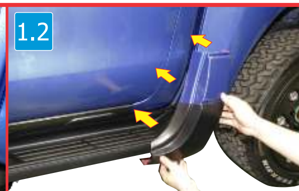
1.1 & 1.2 ) Attach side skirt part 1 and part 2 as shown to marking position. นำชุดสเกิร์ตข้าง มาทาบกับตัวรถ
