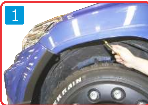
1 ) Loosen the original screw and grommet. ถอดคลิปล็อคพลาสติกออก โดยใช้ไขควงปากแบน
