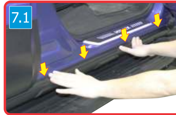
7.1 & 7.2) Press it firmly as shown. กดชุดสเกิร์ตข้าง ให้แน่นติดกับตัวรถ
