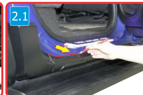
2.1 & 2.2 ) Mark position with crayon as shown. ใช้ดินสอเทียนกำหนดตำแหน่ง เพื่อทาน้ำยารองพื้น(3M)
