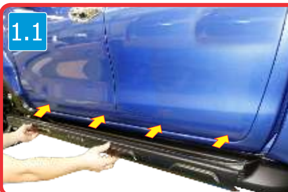
1.1 & 1.2 ) Attach side skirt part 1 and part 2 as shown to marking position. นำชุดสเกิร์ตข้าง มาทาบกับตัวรถ
