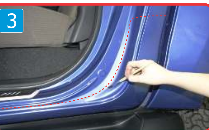
3 ) Please note! Important process. Apply primer (provided) on marking position as shown for better adhesion. สำคัญมากห้ามข้ามขั้นตอนนี้ ทาน้ำยารองพื้น(3M)ก่อนติดตั้ง
