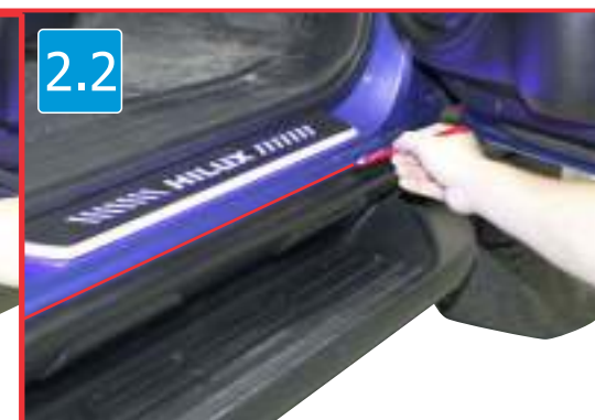
2.1 & 2.2 ) Mark position with crayon as shown. ใช้ดินสอเทียนกำหนดตำแหน่ง เพื่อทาน้ำยารองพื้น(3M)
