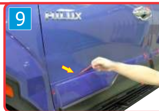
9 & 10) Peel off the rest of double sided tape as shown ลอกเทปกาว(3M)ออกทั้งหมด ดังภาพ
