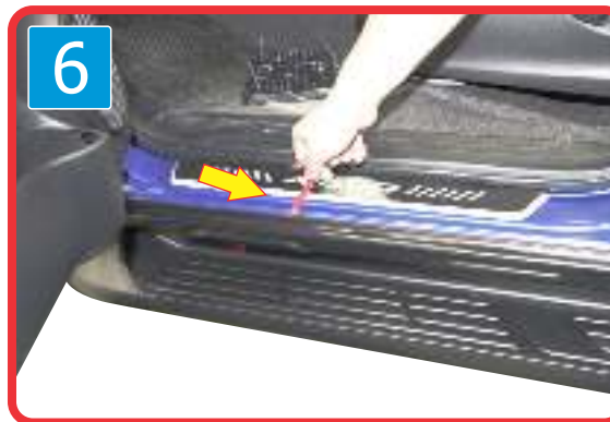
Peel off the rest of double side tape. ลอกเทปกาว (3M) ออกทั้งหมด
