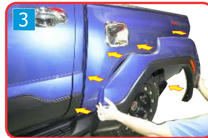
3 ) Attach rear fender flare on car as shown. ทาบครอบซุ้มล้อหลังเข้ากับตัวรถ
