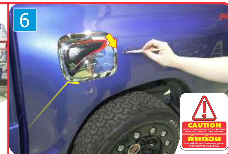
6 ) Please note! Important process. Apply primer (provided) on marking position as shown for better adhesion. สำคัญมากห้ามข้ามขั้นตอนนี้ทาน้ำยารองพื้น(3M)ก่อนติดตั้ง
