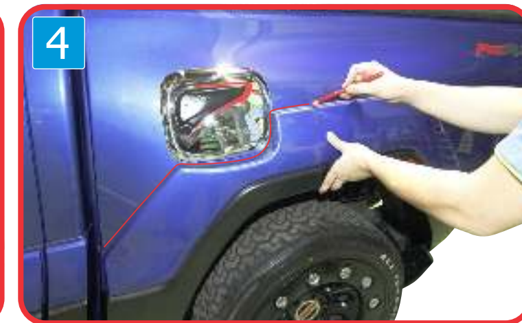
4 ) Mark position with crayon as shown. ใช้ดินสอเทียนกำหนดตำแหน่งเพื่อทาน้ำยารองพื้น(3M)
