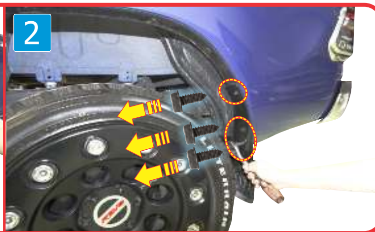
1 & 2 ) Loosen the original screw and grommet as shown. ใช้ไขควงปากแบนถอดคลิปล็อคพลาสติก และใช้ประแจไขสกรูออก ดังภาพ
