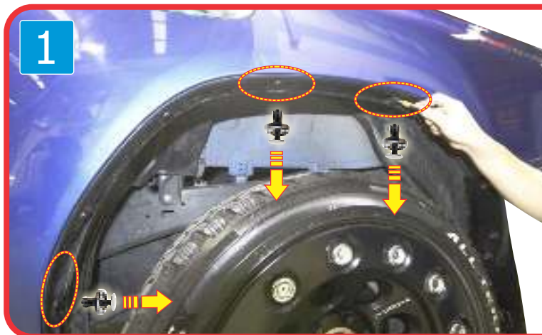
1 & 2 ) Loosen the original screw and grommet as shown. ใช้ไขควงปากแบนถอดคลิปล็อคพลาสติก และใช้ประแจไขสกรูออก ดังภาพ
