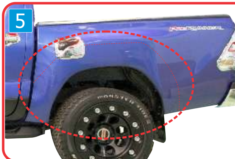
5 ) Correct position (Red cycle) to apply primer ตำแหน่งทาน้ำยารองพื้น(3M)
