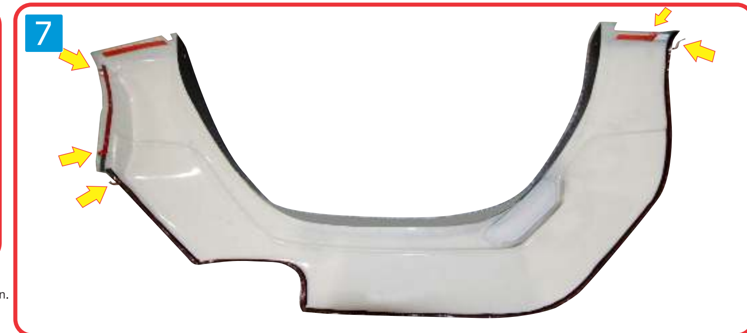
7 ) Peel off small parts of double sided tape a bit on back side of rear fender flare as shown. ลอกเทปกาว(3M)ออกเพียงบางส่วนดังภาพ
