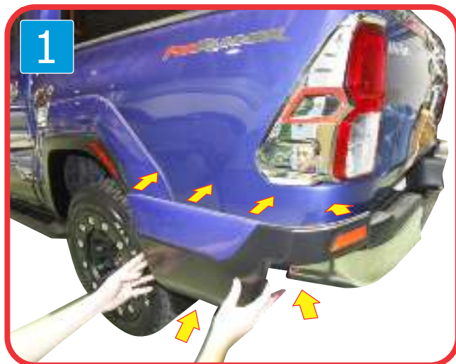
1 ) Attach rear skirt on car as shown. ทาบกรอบสเกิร์ตหลัง เข้ากับตัวรถ
