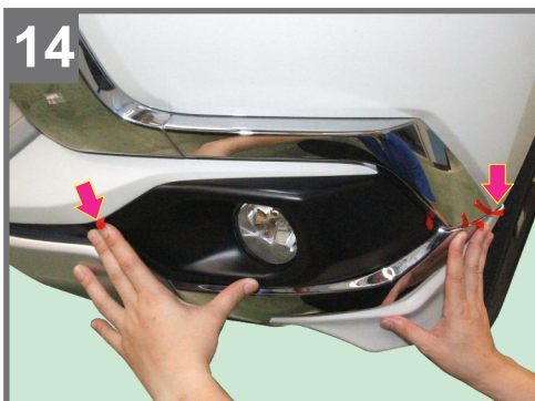
14 Press Front Lower Air Dam the front and rear to vehicles. กดคิ้วโครเมียมชายกันชนหน้า บริเวณด้านหน้าและด้านท้ายให้แนบติดกับตัวรถยนต์ ดังภาพ
