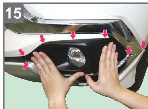
14 Peel off the rest of double side tape then press Front Lower Air Dam firmly as shown. ลอกเทปกาวออกให้หมดและกดคิ้วโครเมียมชายกันชนหน้าให้แนบติดกับกันชนอีกครั้ง ดังภาพ
