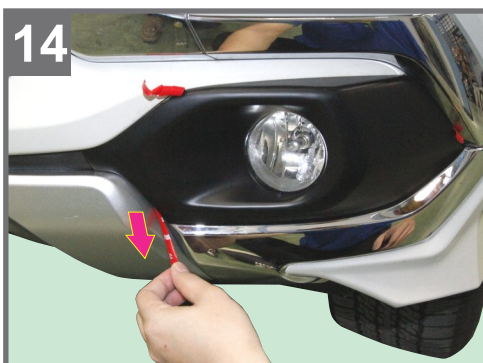
14 Peel off the rest of double side tape then press Front Lower Air Dam firmly as shown. ลอกเทปกาวออกให้หมดและกดคิ้วโครเมียมชายกันชนหน้าให้แนบติดกับกันชนอีกครั้ง ดังภาพ
