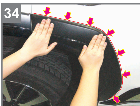
34 Press Rear Fender Flares firmly. กดครอบเสริมซุ้มประตูหลังให้แนบติด กับตัวรถยนต์อีกครั้ง ดังภาพ
