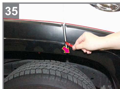
35 Peel off the rest of double sided-tape as shown. ลอกเทปกาวด้านหลังครอบเสริมซุ้มล้อหลัง ออกให้หมด ดังภาพ
