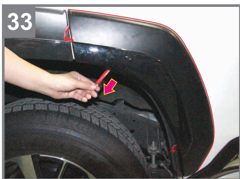
33 Peels off the rest of double sided-tape as shown. ลอกเทปกาวด้านหลังครอบเสริมซุ้มประตูหลัง ออกให้หมด ดังภาพ
