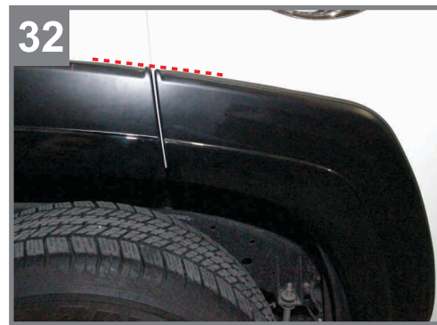
31 Position Rear Fender Flare to mounting position as shown. นำครอบเสริมซุ้มล้อหลังทาบกับตัวรถยนต์ ดังภาพ
