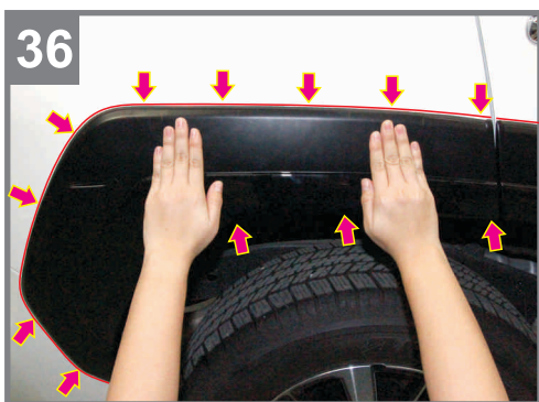
36 Press Rear Fender Flares firmly. กดครอบเสริมซุ้มล้อหลังให้แนบติด กับตัวรถยนต์อีกครั้ง ดังภาพ
