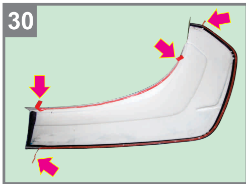
30 Make slight peels from double sided-tape as shown. ลอกเทปกาวด้านหลังครอบเสริมซุ้มล้อหลัง ออกบางส่วน ดังภาพ
