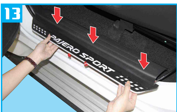
13 Position led door scuff plate to mounting position as shown. ติดตั้งชายบันไดเรืองแสงเข้ากับชายบันไดของรถยนต์ตามภาพ
