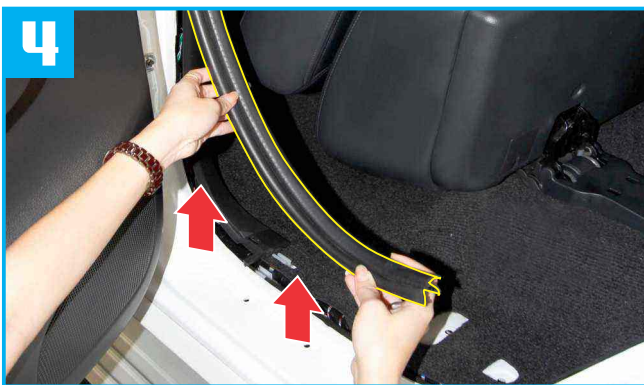
4 Pull rubber rear trim as shown. ถอดยางปิดขอบของประตูหลังออก
