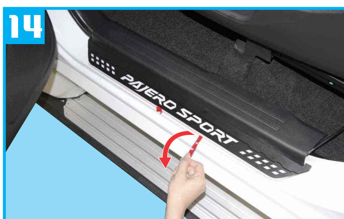
14 Peel off the rest of double sided tape as shown. ลอกเทปกาวออกให้หมด
