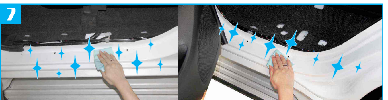
7 Wipe installation area cleaner for better adhesion. เช็ดทำความสะอาดพื้นผิวก่อนการติดตั้ง
