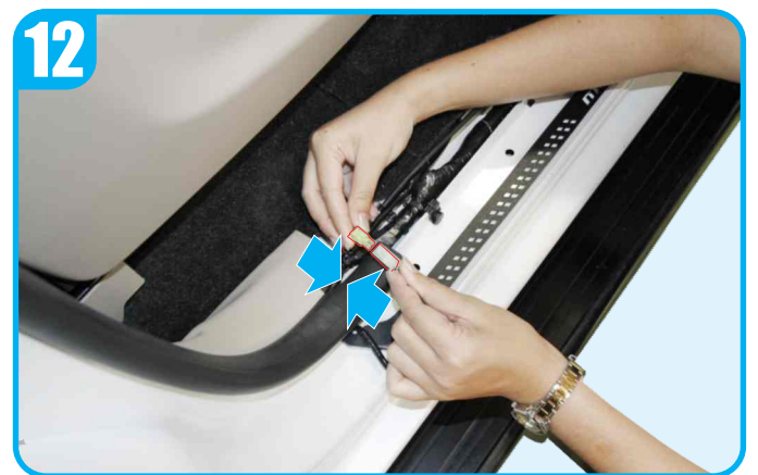
Connect the power cord into the socket of the Lamp. เชื่อมต่อขั้วปลั๊กของชายบันไดเรืองแสงเข้ากับขั้วปลั๊กของชุดสายไฟชายบันไดเรืองแสง
