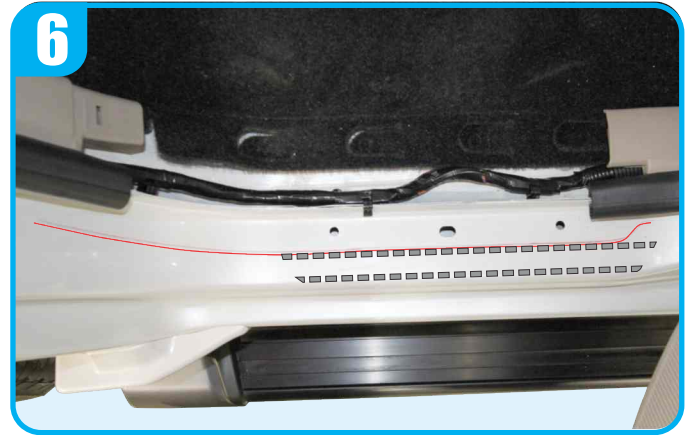
The position after apply primer. ภาพแสดงบริเวณที่ทาน้ำยารองพื้นก่อนติดเทปกาว
