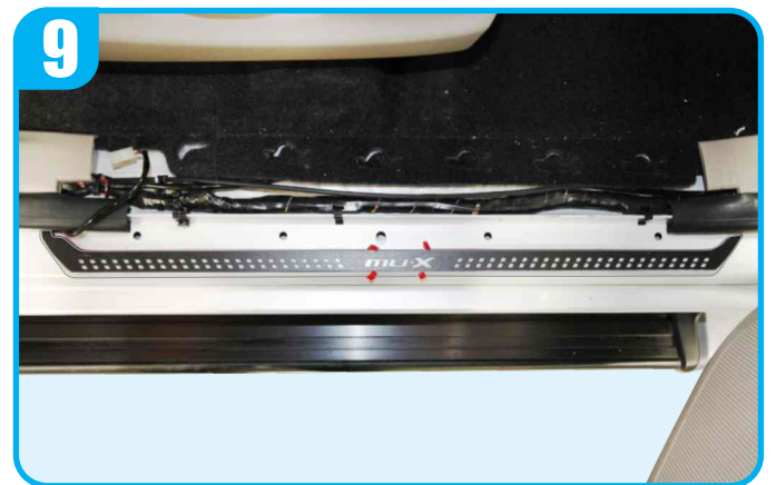
Position LED door scuff plate to mounting position as shown. ติดตั้งชายบันไดเรืองแสงเข้ากับชายบันไดของรถยนต์ ตามภาพ
