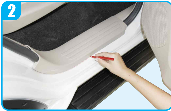
Then mark position with crayon as shown to fix mounting position. ใช้ดินสอเทียนกำหนดแนวการติดตั้ง
