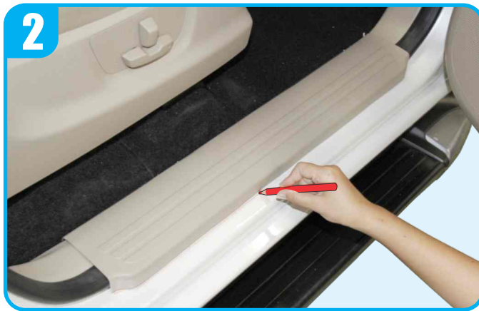
Then mark position with crayon as shown to fix mounting position. ใช้ดินสอเทียนกำหนดแนวการติดกาว
