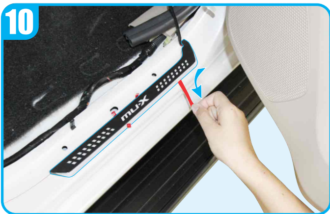
Peel off the rest of double sided tape as shown. ลอกเทปกาวออกให้หมด
