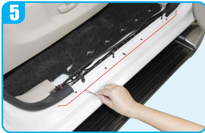
Apply primer ( provided ) before installing for better adhesion. ใช้น้ำยาทารองพื้นก่อนติดตั้งเพื่อเพิ่มการยึดเกาะของเทปกาวอย่างเต็มประสิทธิภาพ
