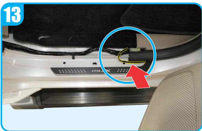
Insert scuff plate with LED wire through the interior cabin as shown. เดินสายไฟชายบันไดเรืองแสงเข้าภายในห้องโดยสารรถยนต์ตามภาพ
