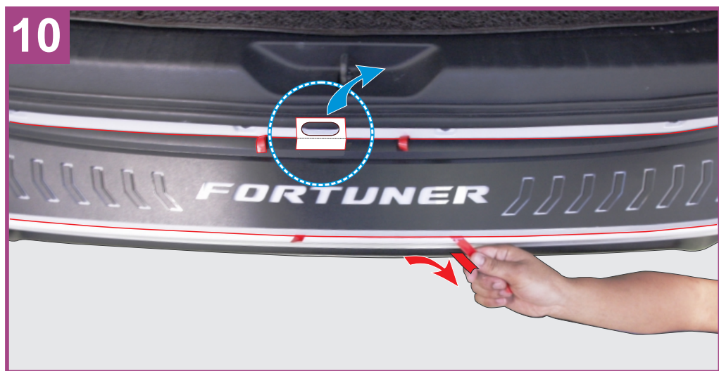
Peel off the rest of double sided tape. ลอกเทปกาวออกให้หมด
