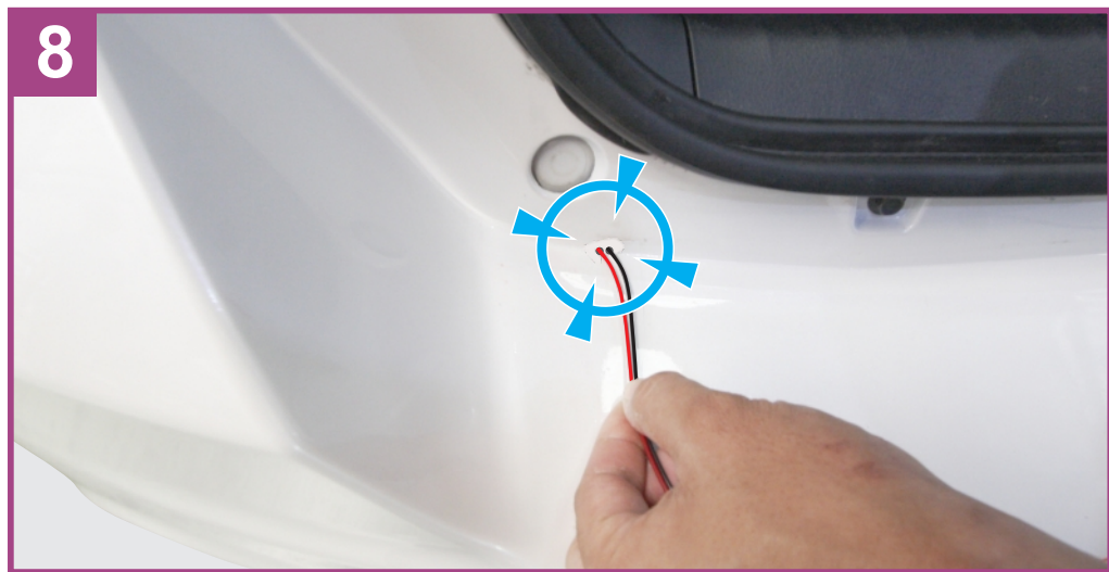
Pull wire through the area as shown. ร้อยสายไฟเข้าในช่องที่เจาะรูไว้ โดยแยกสายไฟให้เข้าคนละช่อง
