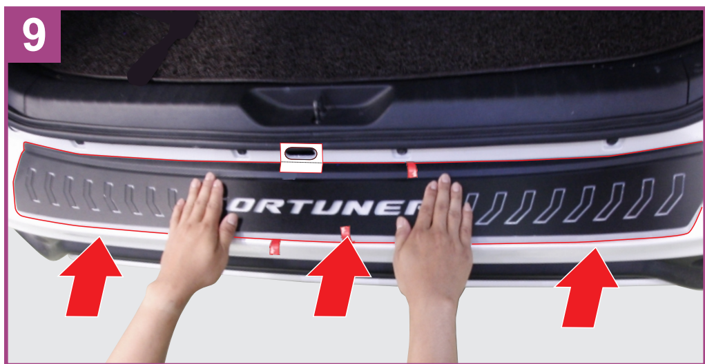
Position door scuff plate with led to mounting position as shown. ติดตั้งกรอบกันรอยท้ายเรืองแสงเข้ากับรถยนต์ตามภาพ
