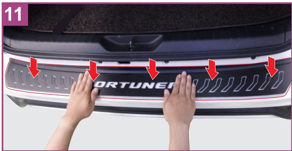
Press it firmly as shown. กดกรอบกันรอยท้ายเรืองแสงให้แนบติดกับรถยนต์อีกครั้ง
