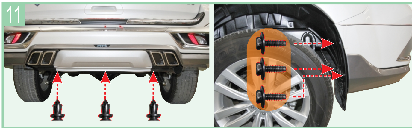
Reassemble screw and grommet to original position as shown ยึดสกรูและคลิปล็อคพลาสติกเข้าตำแหน่งเดิม ตามภาพ
