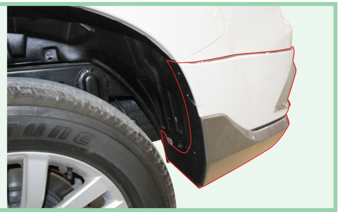
Attached rear skirt with LED to trial fitting on car as shown. ทาบสเกิร์ตหลังให้แนบกับกันชนหลังมากที่สุด แล้วทำการจัดตำแหน่ง ขายึดสเกิร์ตหลังให้ตรงกับรูยึด
