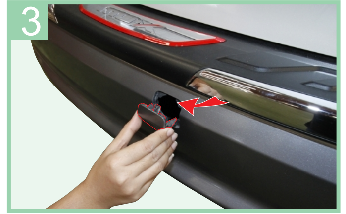
ถอดฝาครอบช่องไขยางอะไหล่เดิมออก ตามภาพ
