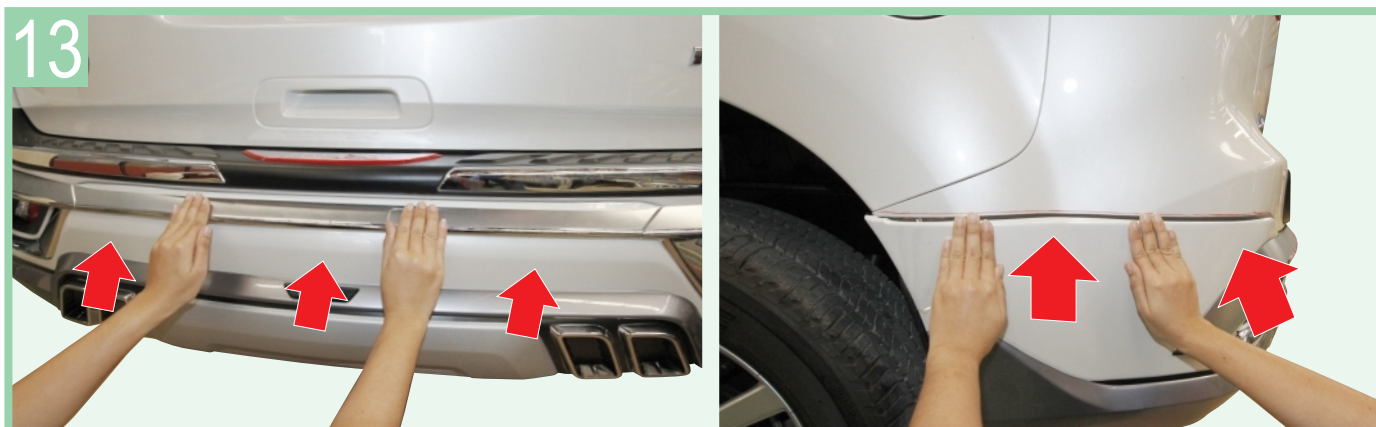
Press rear skirt with LED firmly as shown กดชุดสเกิร์ตหลังให้แน่นสนิทอีกครั้ง ตามภาพ
