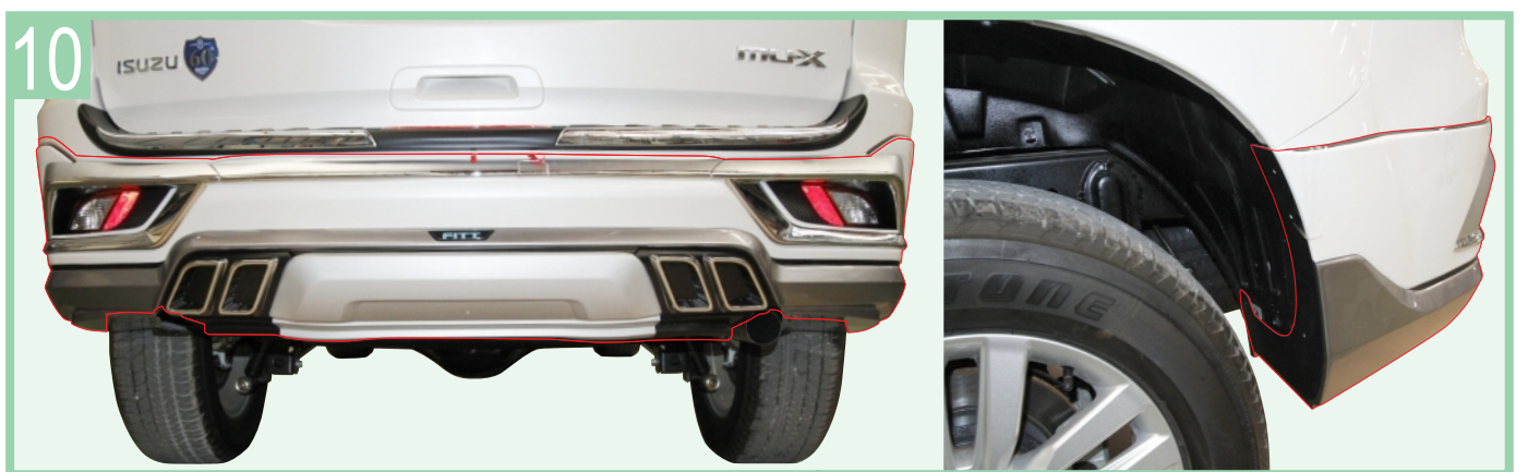
Mounting rear skirt with LED cover original as shown. ติดตั้งชุดสเกิร์ตหลัง ตามภาพ
