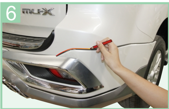
Mark position with crayon as shown then remove Rear skirt with LED from car for step. 7 ใช้ดินสอเทียนกำหนดแนวการประกอบติดตั้ง
