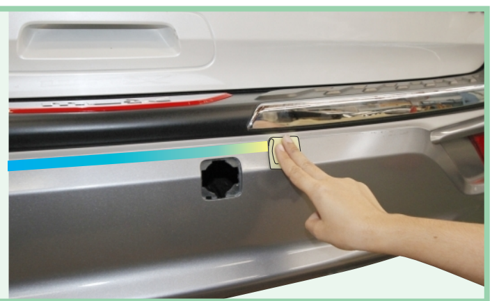
Attached rear skirt with LED to trial fitting on car as shown. ทาบสเกิร์ตหลังให้แนบกับกันชนหลังมากที่สุด แล้วทำการจัดตำแหน่ง ขายึดสเกิร์ตหลังให้ตรงกับรูยึด
