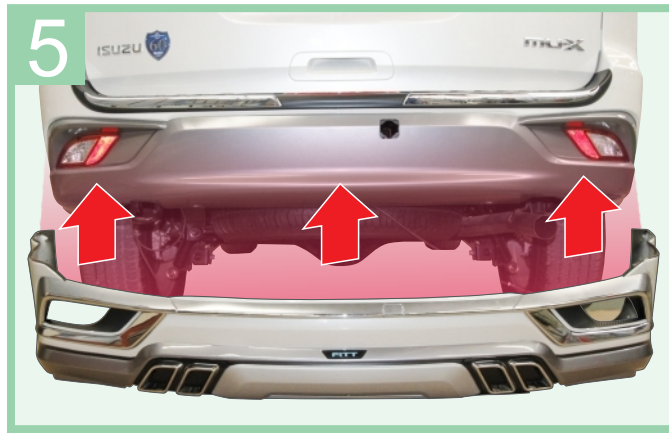
Attached rear skirt with LED to trial fitting on car as shown. ทาบสเกิร์ตหลังให้แนบกับกันชนหลังมากที่สุด แล้วทำการจัดตำแหน่ง ขายึดสเกิร์ตหลังให้ตรงกับรูยึด
