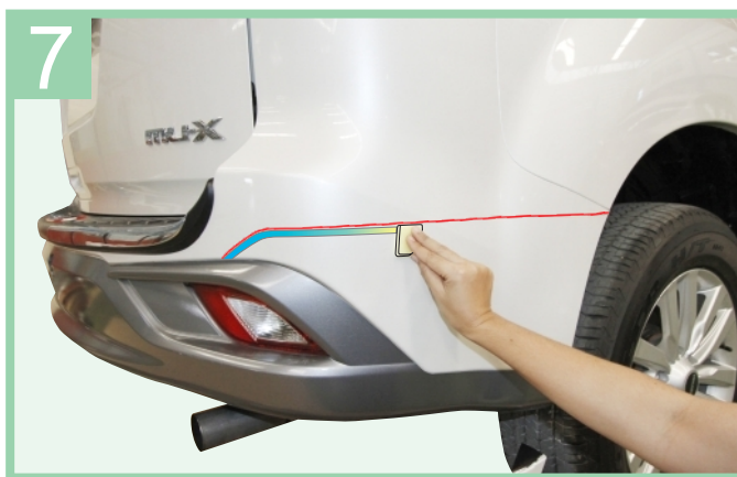
Attached rear skirt with LED to trial fitting on car as shown. ทาบสเกิร์ตหลังให้แนบกับกันชนหลังมากที่สุด แล้วทำการจัดตำแหน่ง ขายึดสเกิร์ตหลังให้ตรงกับรูยึด
