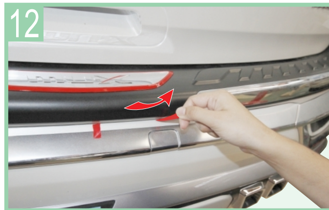
Peel off the rest of double sided tapes as shown ลอกเทปกาวยึดขอบยางสเกิร์ตหลังออกทั้งหมด
