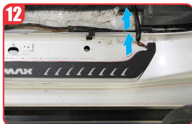
Insert scuff plate with LED wire through the interior cabin as shown. เดินสายไฟชายบันไดเรืองแสงเข้าภายในห้องโดยสาร
