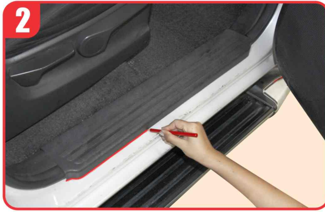
Then mark position with crayon as shown to fix mounting position. ใช้ดินสอเทียนกำหนดแนวการติดกาว
