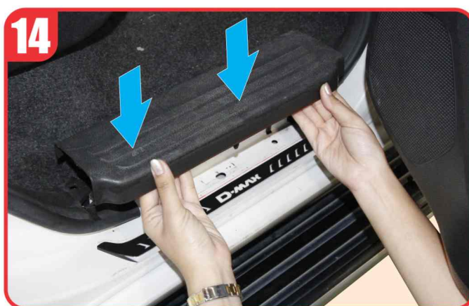
Re-assemble original door scuff plate as image. ประกอบแผ่นกรอบชายบันไดเข้าตำแหน่งเดิม
