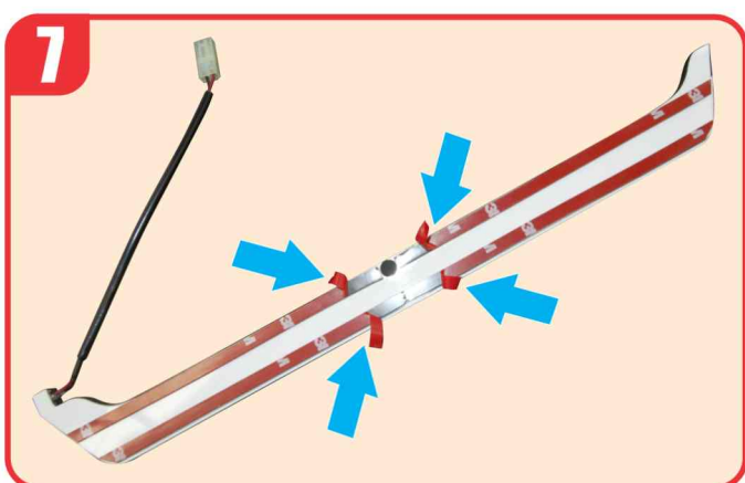
Peel off double sided tape on back side of LED door scuff plate a bit as shown,ลอกเทปกาวชายบันไดเรืองแสงออกเพียงเล็กน้อย
