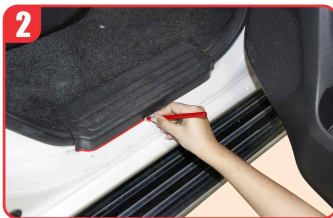
Then mark position with crayon as shown to fix mounting position. ใช้ดินสอเทียนกำหนดแนวการติดกา
