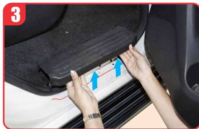
Remove original door scuff plate. ถอดแผ่นกรอบชายบันไดออก
