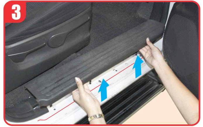
Remove original door scuff plate. ถอดแผ่นครอบชายบันไดออก
