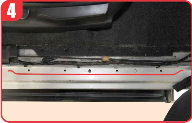
The correct position to mounting LED door scuff plate after marking position with crayon. แสดงตำแหน่งติดตั้งชายบันไดเรืองแสง
