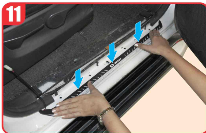
Press the LED door scuff plate firmly to vehicle. กดชายบันไดเรืองแสงให้แนบติดกับรถยนต์อีกครั้ง
