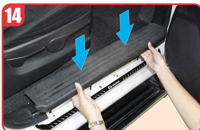
Re-assemble original door scuff plate as image. ประกอบแผ่นครอบชายบันไดเข้าตำแหน่งเดิม
