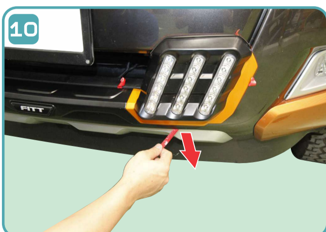
PEEL OFF THE REST OF DOUBLE SIDED TAPE. ลอกเทปกาวออกจนหมด
