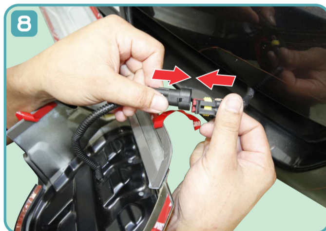
INSERT DRL WIRE. เชื่อมต่อสายไฟ DRL
