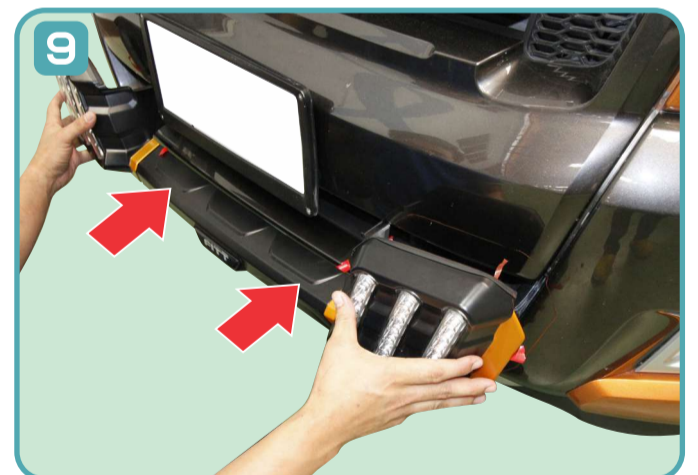
ATTACH DRL ON CORRECT POSITION AS SHOWN. ติดตั้ง DRL เข้ากับกันชนหน้าของรถยนต์ตามภาพ
