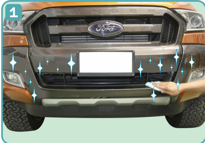
CLEAN AREA WHERE TO APPLY PARTS WITH LIQUID CLEANER FOR BETTER ADHESION. เช็ดทำความสะอาดบริเวณที่ติดตั้ง
