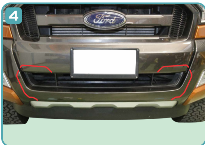
POSITION TO APPLY PRIMER AS SHOWN. ภาพแสดงบริเวณที่ทาน้ำยาทารองพื้นก่อนติดเทปกาว
