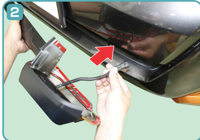
POSITION DRL TO MOUNTING POSITION AS SHOWN. นำ DRL ทาบกับบริเวณที่ติดตั้งโดยให้ขอบของชิ้นงานเข้ากับส่วนโค้งดังภาพ
