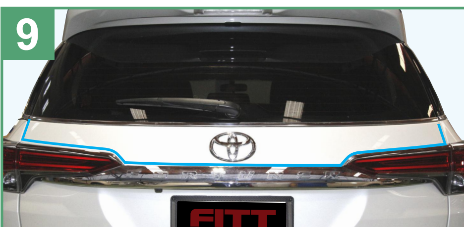
Pre-Fix the primer point as shown. แสดงบริเวณที่ทาน้ำยาทารองพื้นก่อนติดเทปกาว
