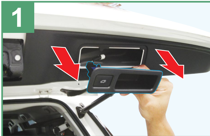
Open rear trunk then remove housing switch ON-OFF as shown ถอดชุดสวิตช์ เปิด-ปิด ประตูหลังออก ดังภาพ
