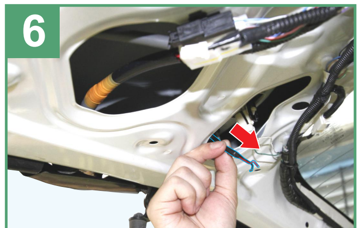
รื้อสายไฟ ของชุดสายไฟเข้าช่องด้านข้างของประตู ดังภาพ
