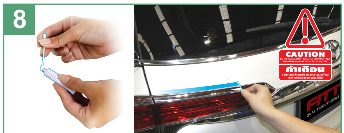
Apply Primer (provided) on position as shown. ทาน้ำยา พรายเมอร์ เพื่อการยึดเกาะของเทปกาว 3M ได้มีประสิทธิภาพ
