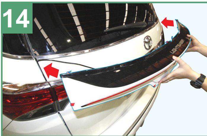
Mounting middle spoiler on position as shown. ติดตั้งกรอบมิตเติ้ลสปอยเลอร์เข้ากับประตูท้ายของรถยนต์ ดังภาพ
