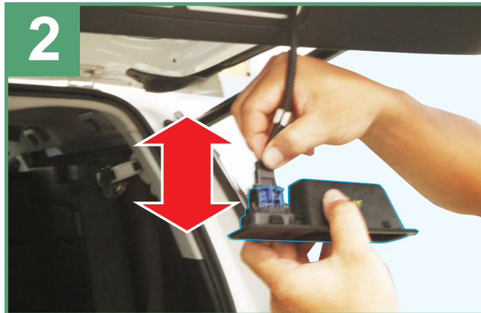
Open rear trunk then remove housing switch ON-OFF as shown ถอดชุดสวิตช์ เปิด-ปิด ประตูหลังออก ดังภาพ
