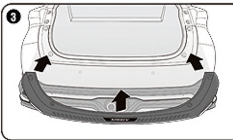
ทำเครื่องหมายตำแหน่งด้วยสีเทียน พร้อมกับใช้สกรูยึดกันชนท้าย ตามภาพ
