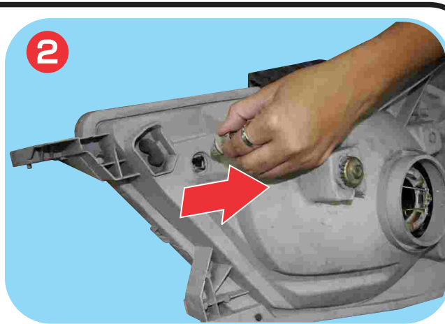
ถอดหลอดไฟหน้า, ไฟหรี่และไฟเลี้ยวของเดิมออก
