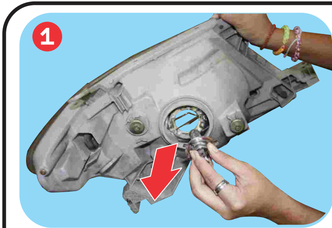
ถอดหลอดไฟหน้า, ไฟหรี่และไฟเลี้ยวของเดิมออก
