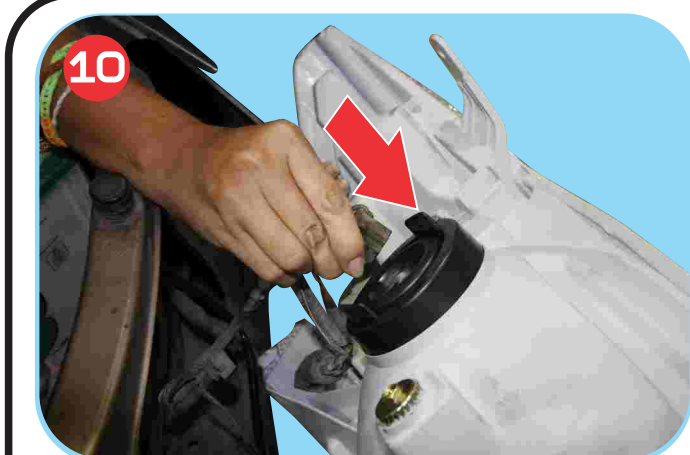
ประกอบปลั๊กไฟหน้า, ไฟหรี่และไฟเลี้ยวเข้ากับไฟหน้า DRL
