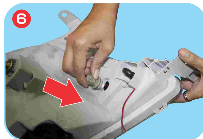
ติดตั้งขั้วหลอดไฟหรี่เข้ากับไฟหน้า DRL
